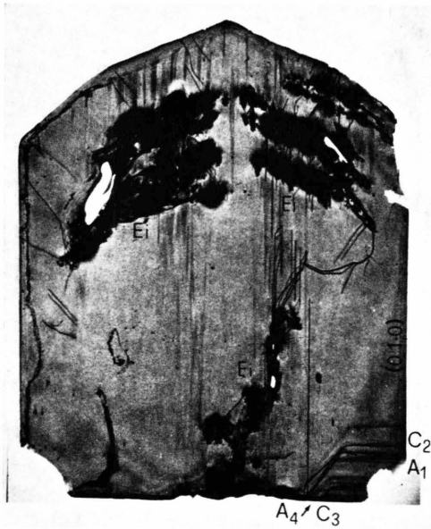
Abb. 6. Platte parallel (100), \sim 0,6 mm dick, horizontale Dimension 16 mm, aus einem in -c -Richtung gewachsenen Kristallbereich geschnitten. [001] vertikal. Ei = Einschlüsse. \lambda = 1,54 \text{ \AA} , Reflex (002).
